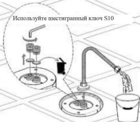
С помощью шестигранного ключа S10 снимите соответствующие детали для проведения испытаний с подачей воды и промывки для удаления загрязнений.
